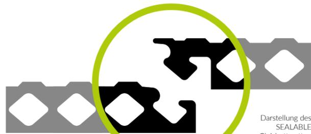
Darstellung des SEALABLE Gleisbettmatten „Click & Connect“ Systems, ein einfach zu handhabender Verbindungsmechanismus für die leichte Montage
